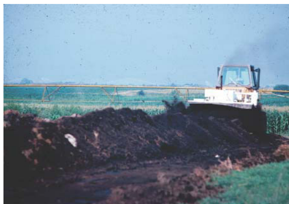
Retournement d'un andain de fumier de bovin composté à l'aide d'un vire-andains à vis Brown Bear.
